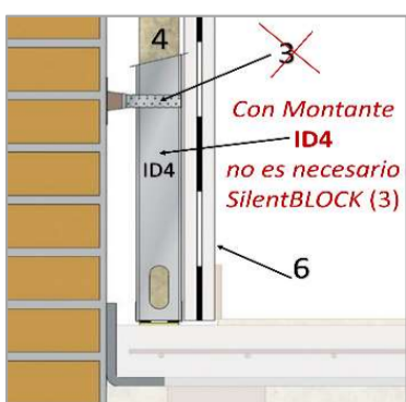
4 Absorbente SemiRIGIDO 6 Sandwich PYL+Membrana+PYL
